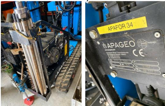
**Lot n° 25 - Foreuse pénétromètre dynamique APAFOR APAGEO H100 avec accessoires (+-1000h)**
